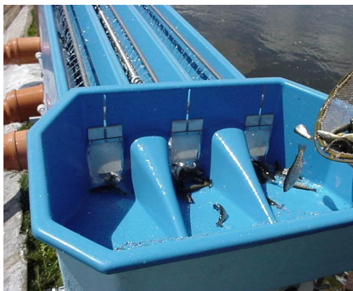
Рисунок 5.28 - Автоматическое устройство для сортировки рыб (AFGM 0101)
