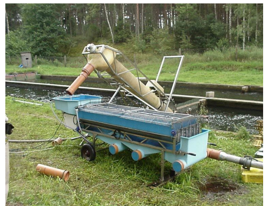
Рисунок 5.28 - Автоматическое устройство для сортировки рыб (AFGM 0101)
